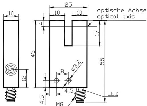
Der optische Sensor **OGDM...** wurde entwickelt um Druckmarken auf transparenten Medien zu erkennen, wie sie z.B. in der Verpackungsindustrie vorkommen. Weißes Sendelicht wird bei einem hohen Kontrast der Druckmarken verwendet, blaues Sendelicht bei einem geringen Kontrast der Druckmarken.
